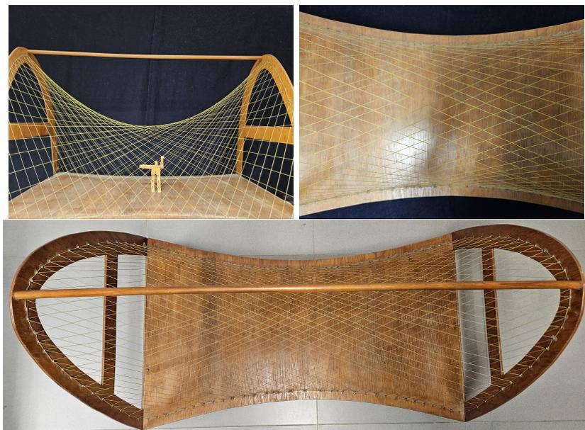
Figure 7: Modelo de la Silla de Montar terminado
